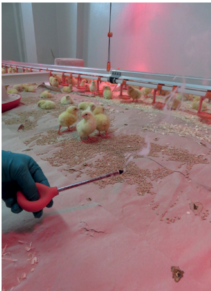
Abbildung 20: Mit Hilfe von Strömungsprüfröhrchen kann die Luftbewegung im Stall sichtbar gemacht werden. Sie helfen dabei z. B. Zugluft zu erkennen. (© Prof. H. Louton)
