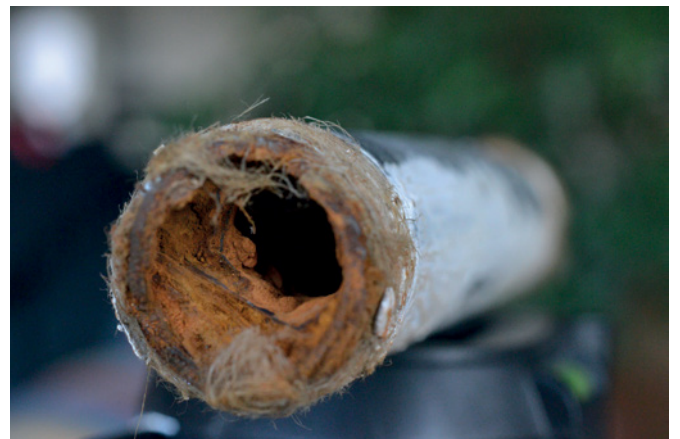
Abbildung 13: Dieses Leitungsrohr musste ausgetauscht werden, nachdem sich im Laufe der Zeit massive mineralische Ablagerungen gebildet haben. (© Dr. B. Spindler)
