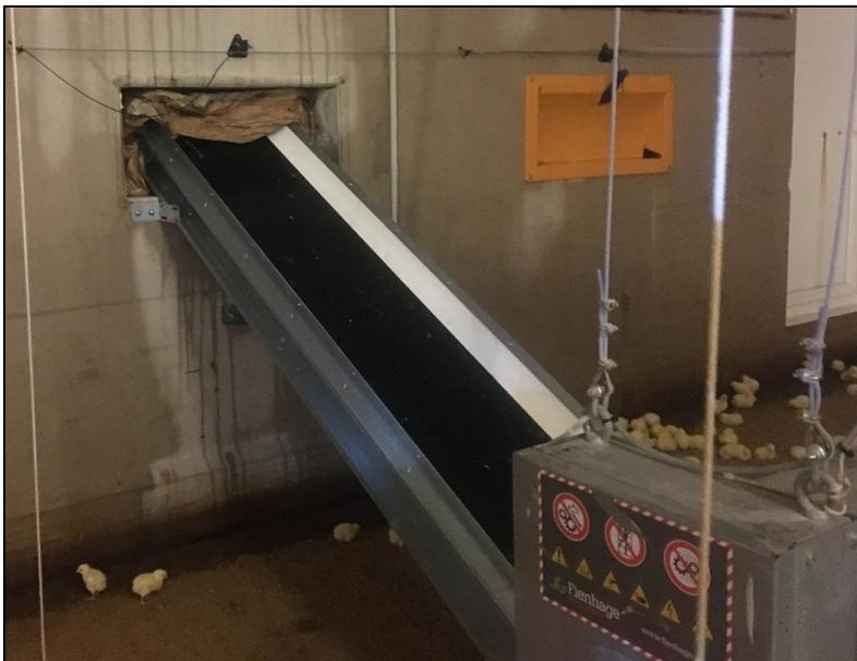
**Abbildung 5:** Verlängerung des Kotbandes zur Förderung von Kot aus dem Stall.
