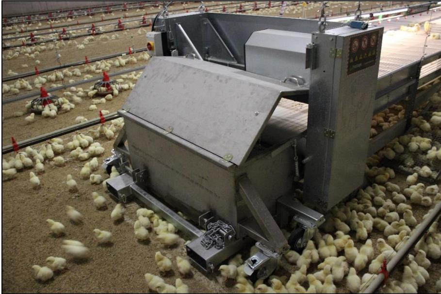
**Abbildung 6:** Sammelkiste vor dem Kotband zur Zwischenlagerung von Kot.
