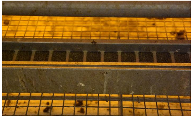
Ein Kükenschutzgitter hilft, dass Kühen beim Laufen der Futterkette nicht „mitfahren“ und eingequetscht werden
